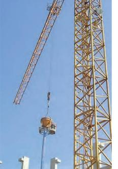
Abb. 1: Turmdrehkran mit Personenaufnahmemittel (Betonkübel mit Standplatz) – nationaler Regelungsbereich
