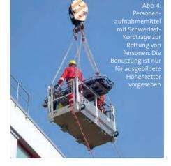
rüstete Seilbagger sein (TRBS 2121 Teil 4 [2]). Sie sind bestimmungsgemäß nicht zum Heben von Personen sondern zum Heben von Lasten vorgesehen. Winden können bestimmungsgemäß für die Personenbeförderung ausgelegt sein. Wird eine verwendungsfertige Einrichtung, bestehend aus Personenwinde und Personenaufnahmemittel, in den Verkehr gebracht, so unterliegt sie dem Anwendungsbereich der Maschinenrichtlinie.
