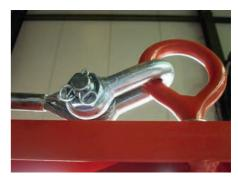
Abb. 11: Nur mit Werkzeug lösbar – Schäkel gerade Form mit Mutter und Splint
