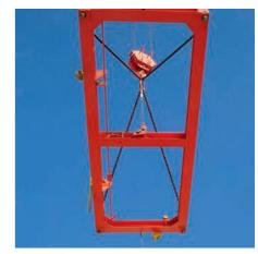
Abb. 12: Spreader zum Anschlagen von Baustellen-Containern mit Normecken
