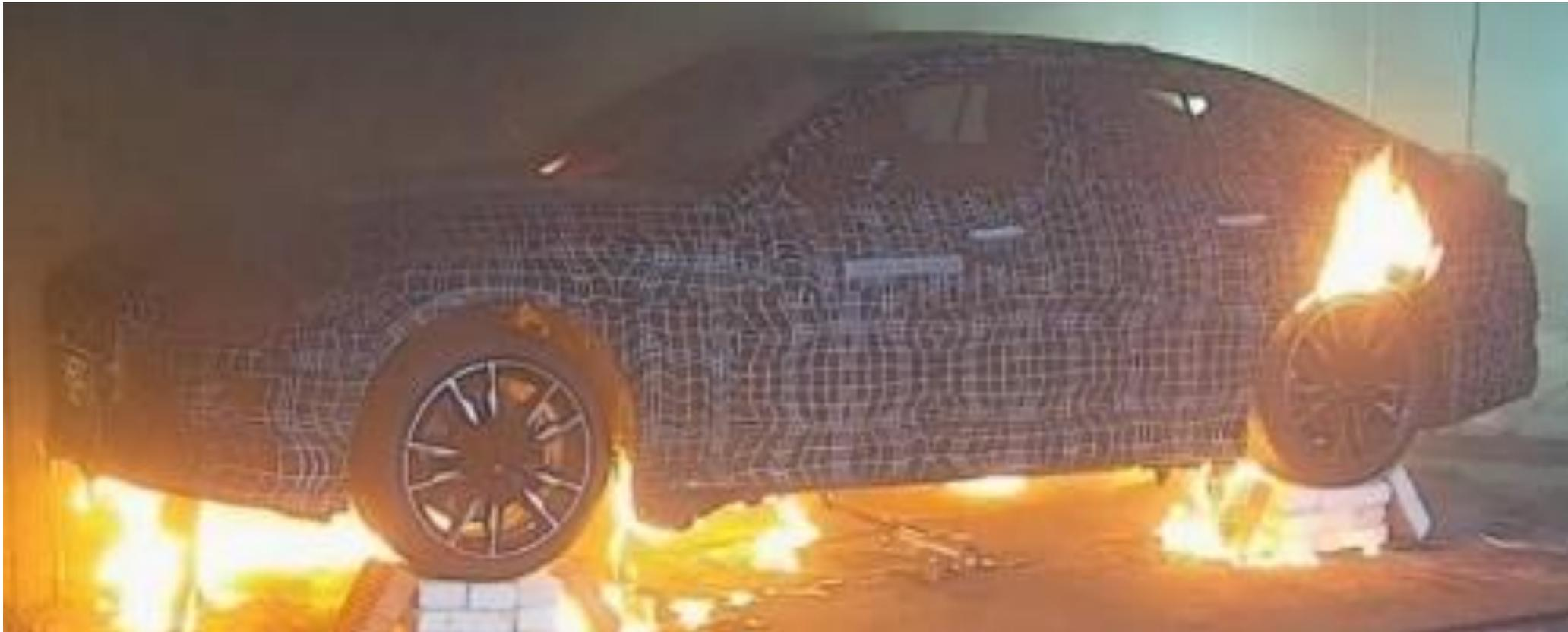
Bekämpfung des Batteriebrandes mit HSR:
