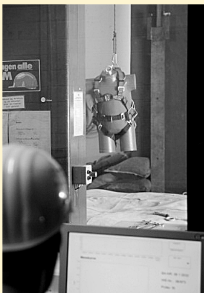
Abb. 2: Prüfung eines Auffanggurtes
