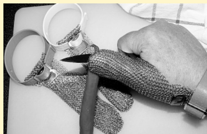
Abb. 2: Der Daumenschutz ist – wie die Handschuhe auch – in mehreren Größen (Farbcode!) verfügbar
