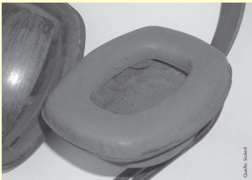
Abb. 6: Ablegereifer Kapselgehörschutz mit leistungsmindernden Beschädigungen.
