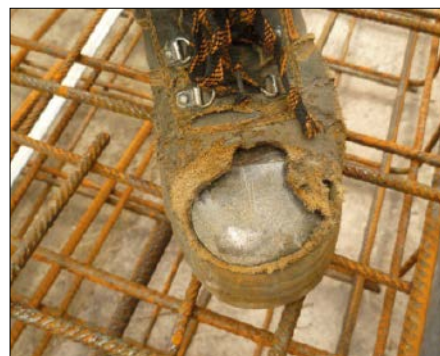
Abb. 1: Abgeregelter Sicherheitsschuh; Zehenkappe liegt frei
