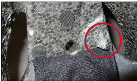
Abb. 4: Ablösung einer zur Befestigung des Innenpolsters aufgeklebten Klettverbindung.
