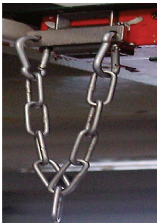
Abb. 4 Manipulierter Positionsschalter – abgeschraubter Betätiger eingesteckt und mit Kette versehen (© DGUV)
