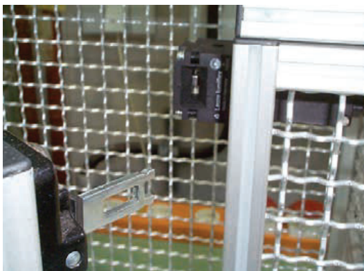
Abb. 1 Positionsschalter mit getrenntem Betätiger (© DGUV)
