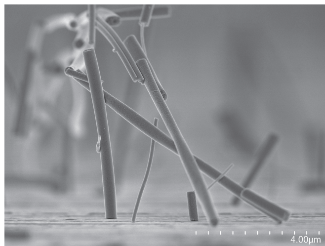
Bild 1. Rasterelektronenmikroskopische Seitenansicht von mit einem elektrostatischen Präzipitator auf einem leitfähigen Substrat gesammelten Nano- und Mikrofasern (TiO 2 ).
