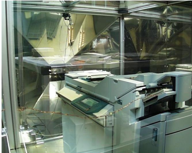
Abbildung 2-2: Prüfkabine für Drucker und Kopierer
