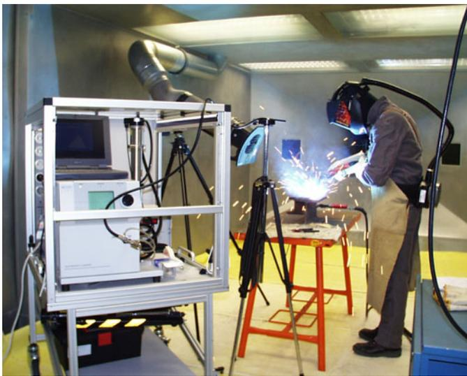
Abbildung 2-8: Messung ultrafeiner Partikeln beim Schweißen
