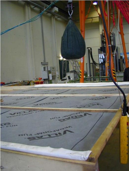
Abbildung 2-28: Prüfung von Dachunterspannbahnen
