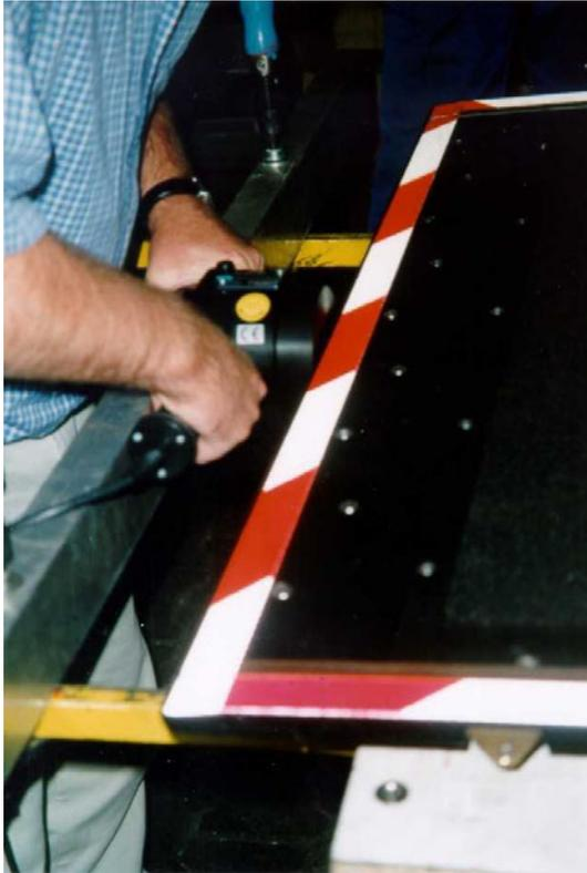
Abbildung 2-27: Kraftmessung an einer ausfahrenden Rampe
