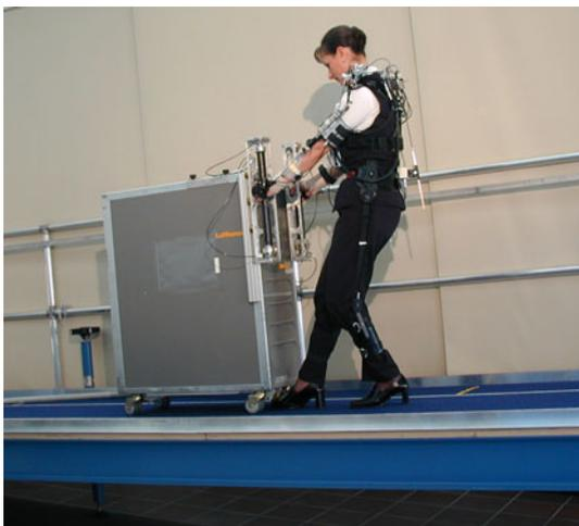
Abbildung 2-20: Messung der Muskel-Skelett-Belastung beim Ziehen eines Trolleys
