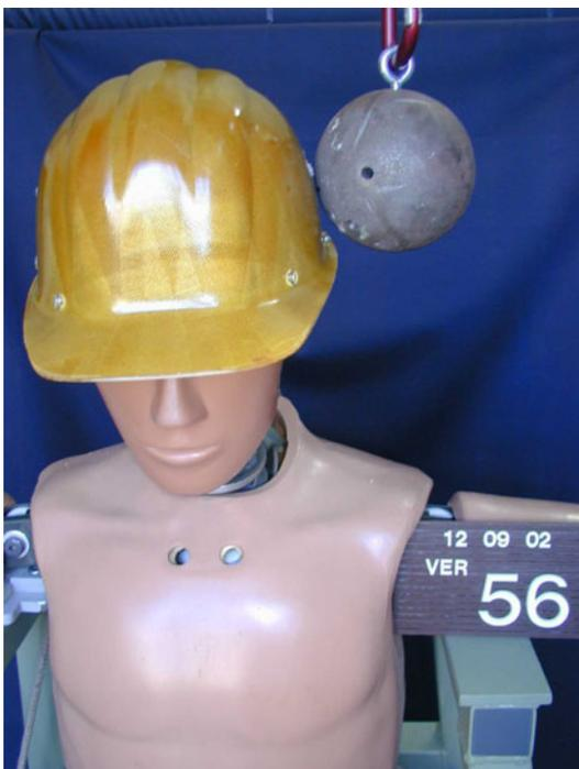
Abbildung 2-21: Seitenaufpralltest für Industrieschutzhelme
