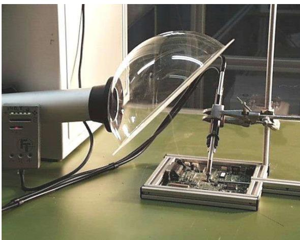
Abbildung 2-12: Prüfstand für Lötrauchemissionen
