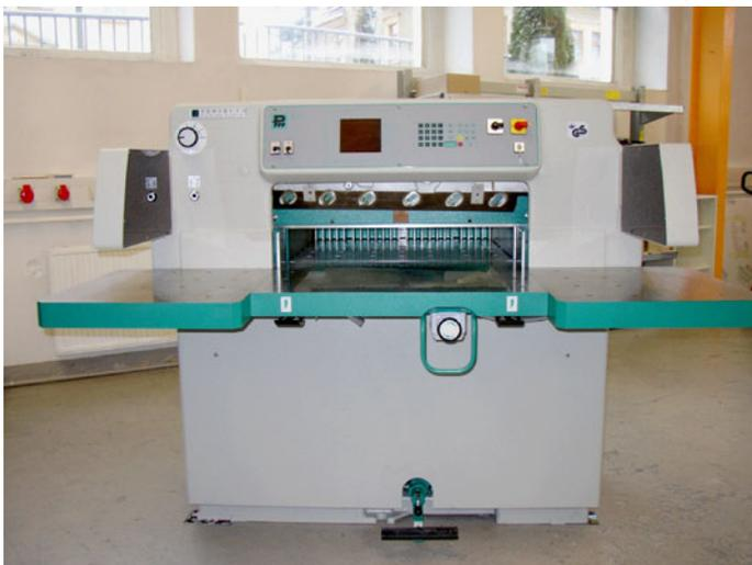
Abbildung 2-24: Planschneidemaschine
