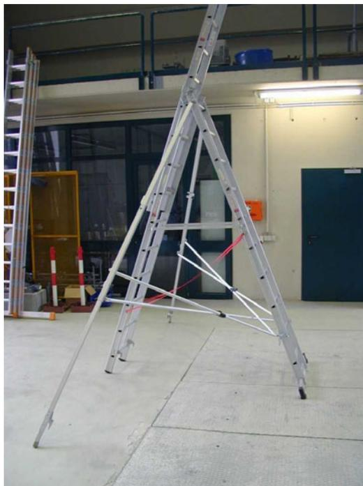
Abbildung 2-26: Stehleiter mit seitlichen Stützen
