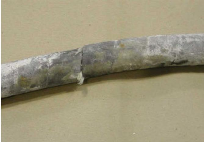
Abbildung 2-25: Mörtelförder-Schlauchleitung mit Defekt
