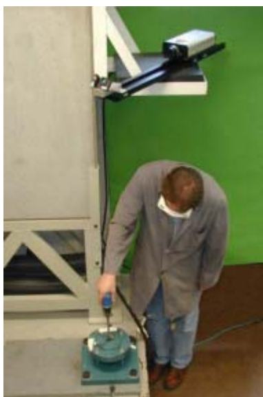
Abbildung: Vergleichsmessung piezoelektrischer Beschleunigungsaufnehmer mit LASER-Vibrometer
