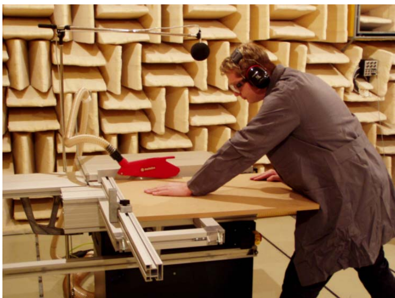
Abbildung Bestimmung der Geräuschemission beim Sägen im Semi- Schallschluckraum
