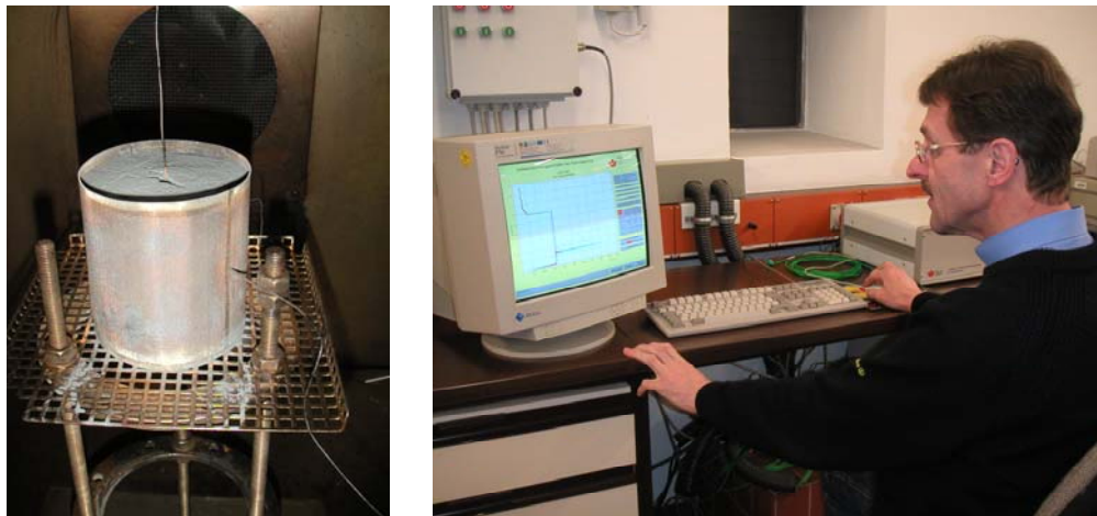
Abbildung 2-18: Bestimmung des Selbstentzündungsverhaltens einer Staubprobe
