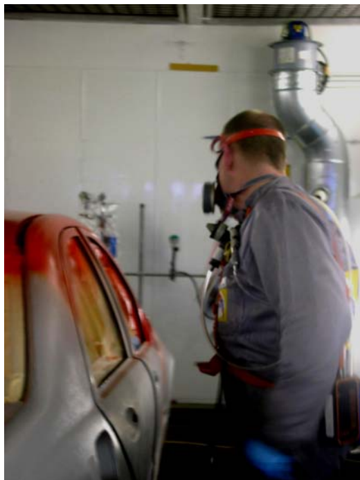
Abbildung 2-15: Sprühnebel bei der Reparaturlackierung mit Polyurethanlacken
