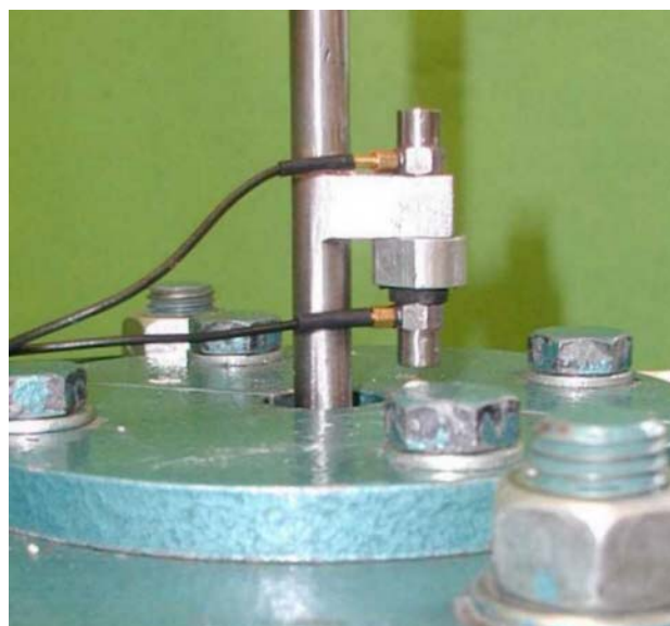
Abbildung: Vergleichsmessung piezoelektrischer Beschleunigungsaufnehmer mit LASER-Vibrometer
