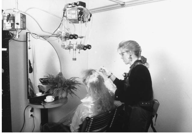
Abbildung 33: Expositions-messung beim Blondieren: Friseurin beim Auftragen des Blondiermittels; Probenahmeeinrichtungen an der Person sowie stationär in Atemhöhe oberhalb der Kundin
