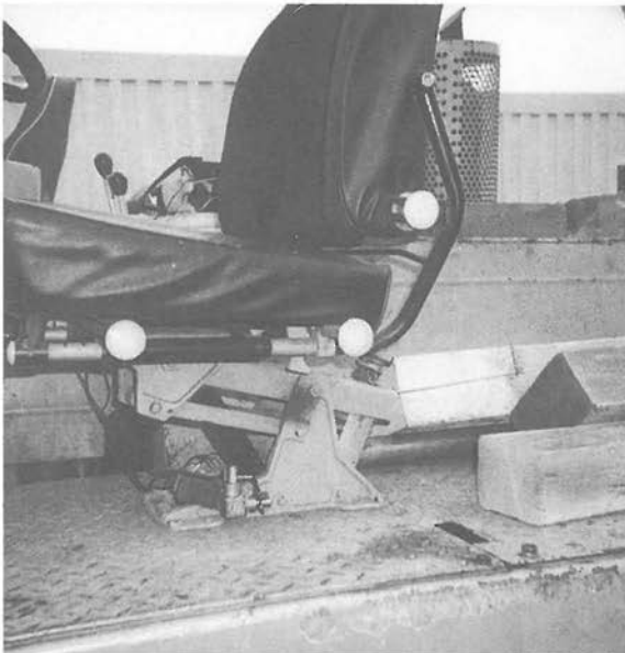
Abbildung 43: Ankopplung der Beschleunigungs- aufnehmer
