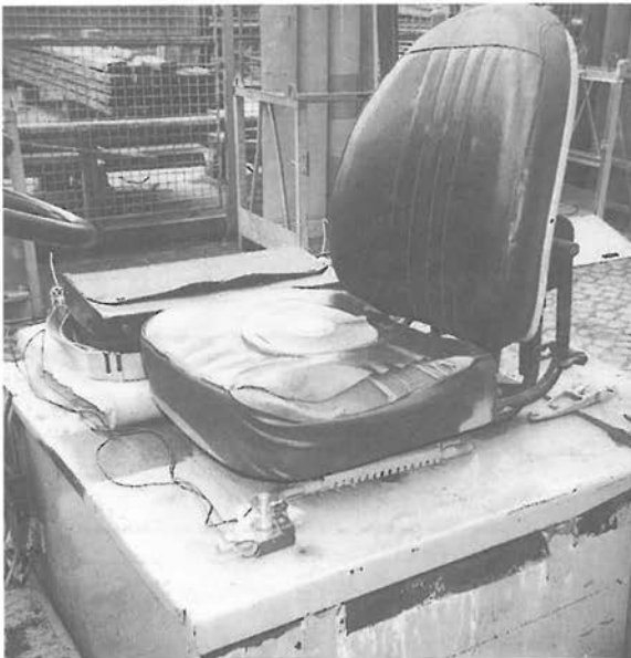
Abbildung 18: Beschleunigungsaufnehmer, Dreikomponentenaufnehmer und Meßmagnetbandgerät
