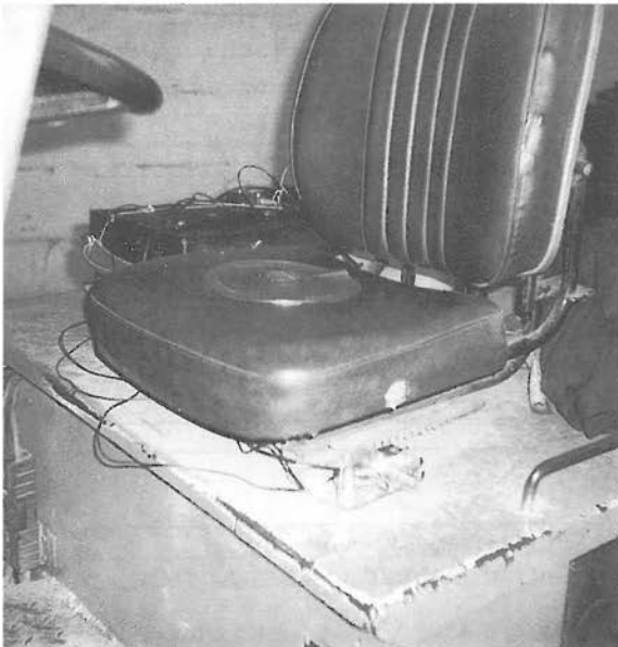
Abbildung 38: Beschleunigungsaufnehmer, Dreikomponentenaufnehmer und Meßmagnetbandgerät
