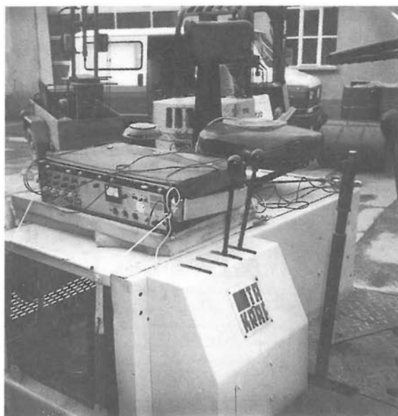
Abbildung 7: Dreikomponentenaufnehmer und Meßmagnetbandgerät
