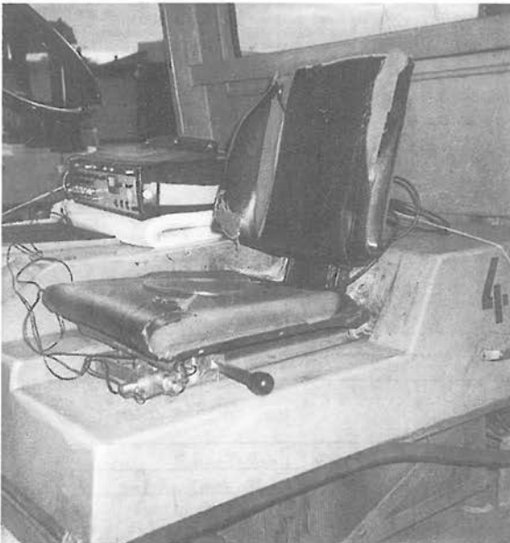
Abbildung 30: Beschleunigungsaufnehmer, Dreikomponentenaufnehmer und Meßmagnetbandgerät
