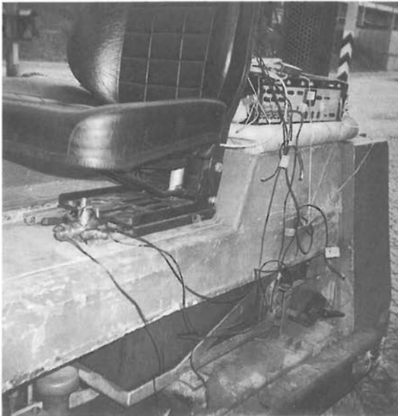
Abbildung 46: Beschleunigungsaufnehmer, Dreikomponentenaufnehmer und Meßmagnetbandgerät
