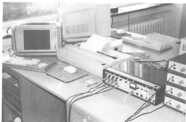
Abbildung 5: Auswertung Terzspektrum und spektrale Leistungsdichte: — Magnetbandgerät 7007 — Drucker — Portable mit Fourieranalysator FA 104
