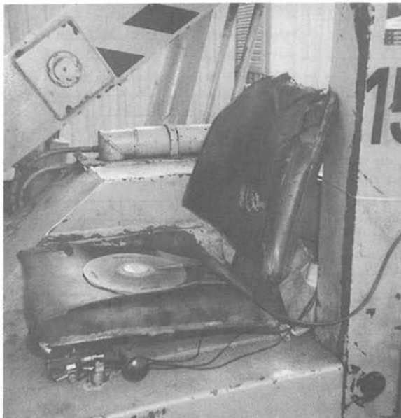
Abbildung 34: Beschleunigungsaufnehmer, Dreikomponentenaufnehmer und Meßmagnetbandgerät
