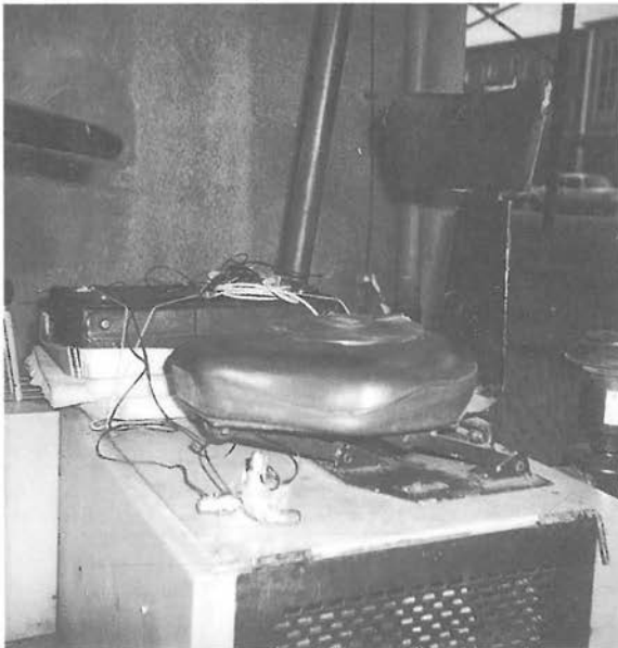
Abbildung 4: Beschleunigungsaufnehmer, Dreikomponentenaufnehmer und Meßmagnetbandgerät
