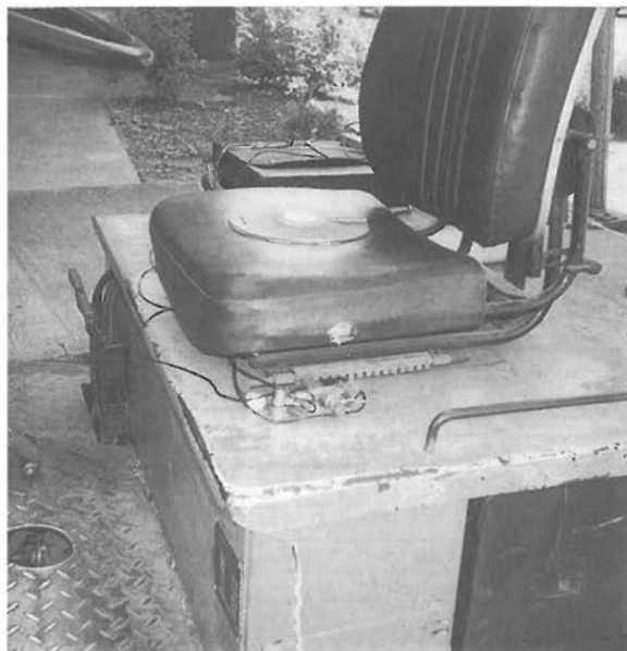
Abbildung 41: Beschleunigungsaufnehmer, Dreikomponentenaufnehmer und Meßmagnetbandgerät
