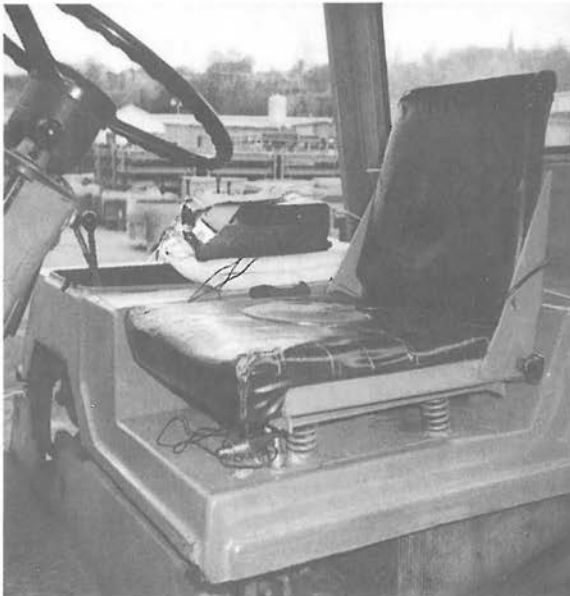
Abbildung 26: Beschleunigungsaufnehmer, Dreikomponentenaufnehmer und Meßmagnetbandgerät
