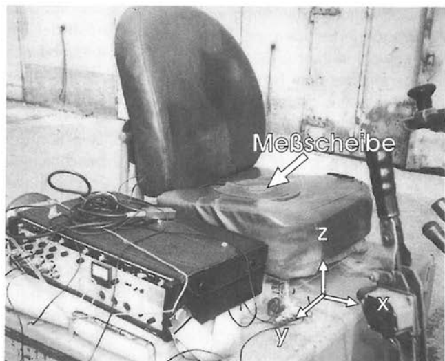
Abbildung 3: Schema der Meßausrüstung
