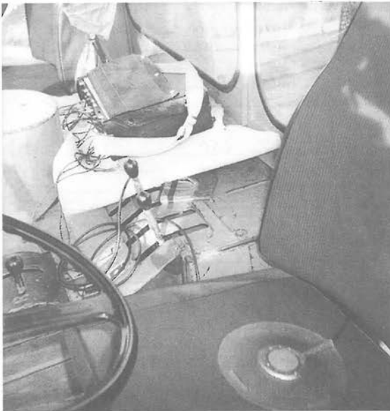
Abbildung 50: Beschleunigungsaufnehmer, Dreikomponentenaufnehmer und Meßmagnetbandgerät
