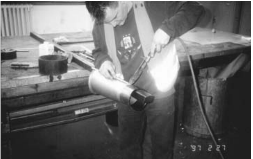
Abbildung 25: Abluftstutzen weichlöten (A 23)
