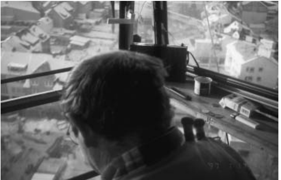
Abbildung 26: Arbeitsplatz des Turmdrehkranführers B 13
