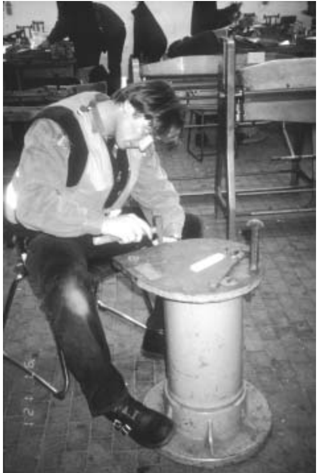
Abbildung 22: Kaminverwahrung anfertigen (A 15)
