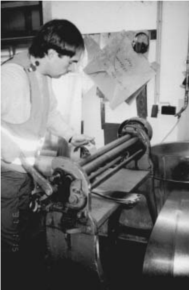
Abbildung 20: Bleche walzen und wickeln (A 12)
