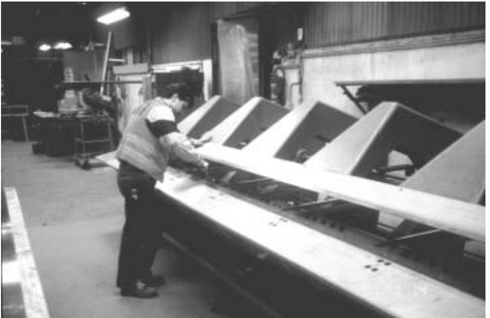
Abbildung 19: Abkantbank bedienen (A 11)
