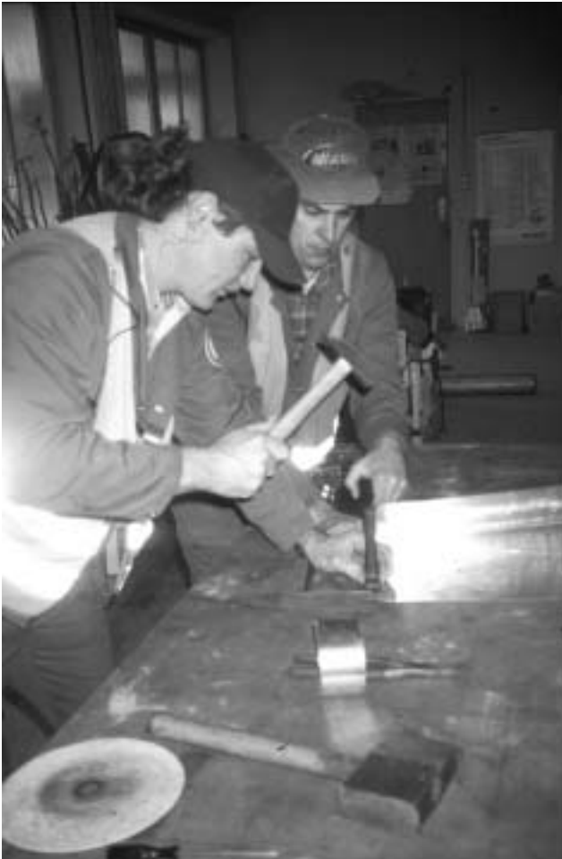
Abbildung 27: Bleche falzen (A 26 und A 27)
