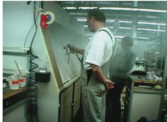
Abbildung 2: Lösungsmittlemissionen beim Verkleben von Pkw-Interieurteilen
