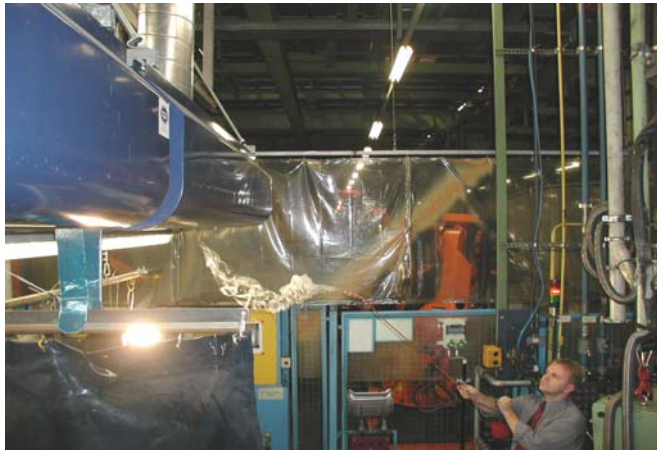
Abbildung 5: Darstellung der Wirkungsweise der Drallerfassungselemente mittels Rauchversuchen
