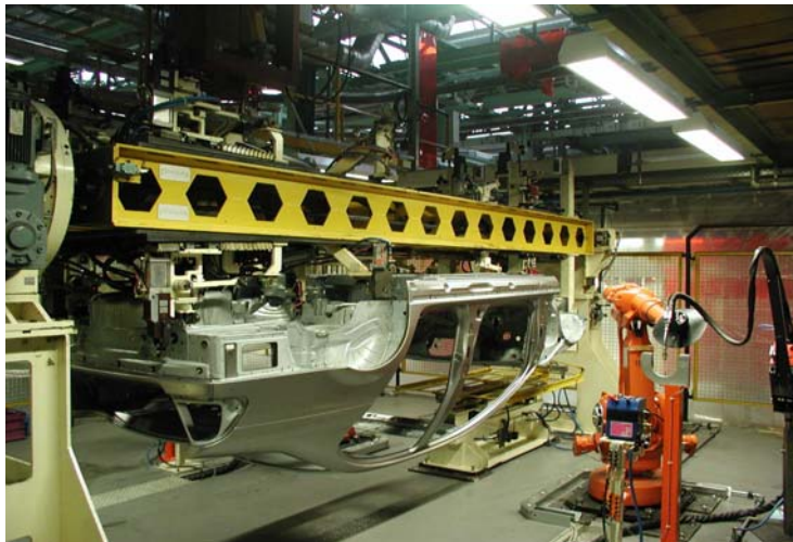
Abbildung 8: Darstellung der Ausschweißtrommel (Kopfstand)
