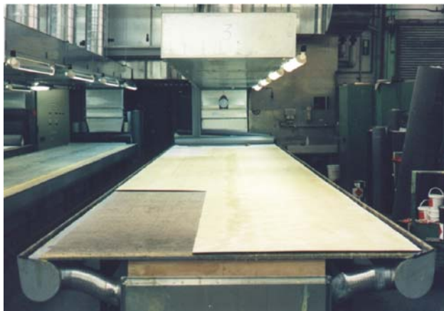
Abbildung 9: Beispiel für einen Klebetisch mit seitlich angeordneten Wirbelhauben und oberer impulsarmer Luftzufuhr [8]
