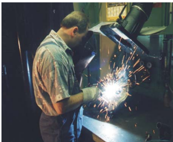
Abbildung 6: Beispiel für einen Schweißarbeitsplatz mit einer Düsenplatte an einem beweglichen Absaugarm
