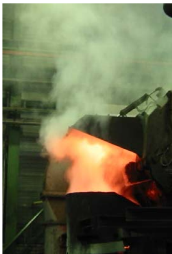
Abbildung 14: Rauchemissionen beim Schmelzen von Gusseisen
