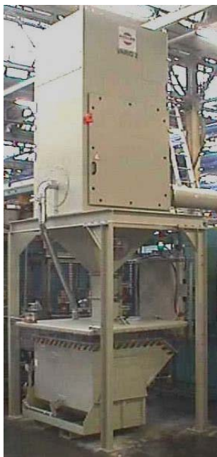
Abbildung 6: Trocken filternder Abscheider zur Absaugung und Abscheidung von Spänen und Staub
