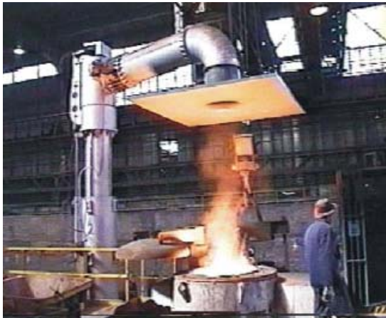
Abbildung 12: Strömungsverhältnisse an einem Schmelzofen mit Düsenplatte
