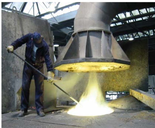
Abbildung 16: Erfassung von Rauchemissionen mittels einer Düsenplatte
