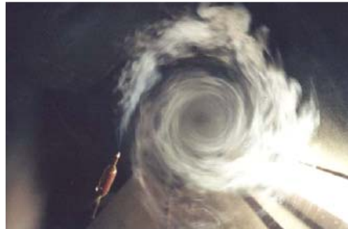
Abbildung 15: Spiralförmige Stromlinien in der Wirbelhaube
