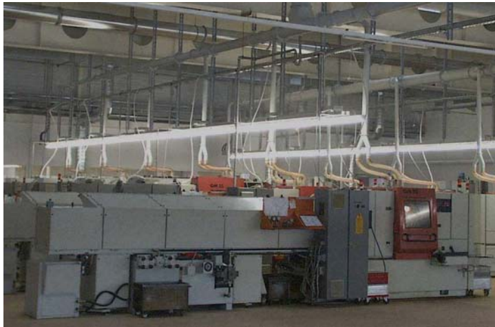
Abbildung 2: Absauganschlüsse an vollständig gekapselten Werkzeugmaschinen
