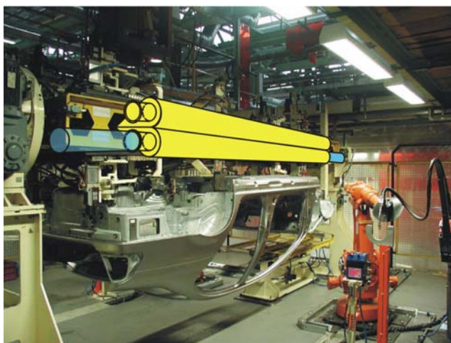
Abbildung 10: Darstellung der Ausschweißtrommel mit eingezeichneter Doppeldrallhaube (Kopfstand)
