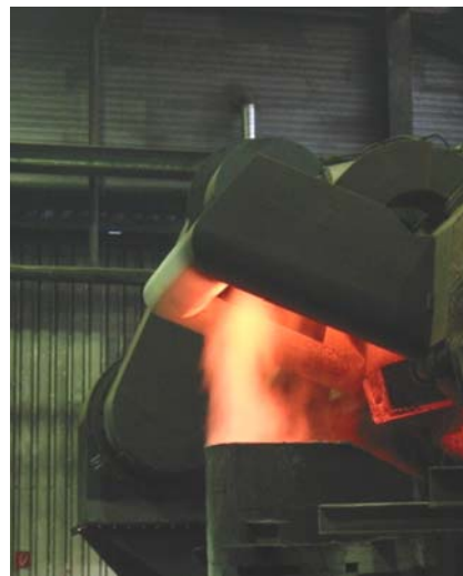
Abbildung 15: Erfassung von Rauchemissionen mittels dreiseitig umlaufender Drallhaube
