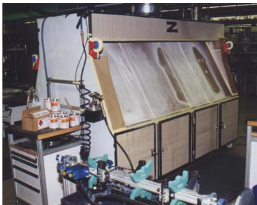
Abbildung 1: Spritzstand zum Verkleben von Pkw-Interieurteilen
