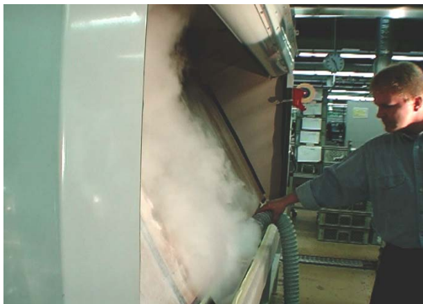
Abbildung 4: Erfassung von Lösemittlemissionen am Spritzstand mit einer rundumlauf- enden Drallerfassung
