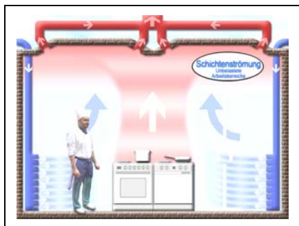
Abbildung 3: Beispiel für eine Schichtenströmung mit bodennahen Luftdurchlässen
