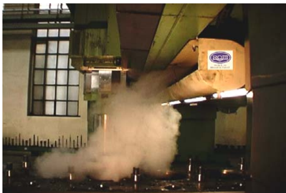
Abbildung 13: Erfassung von Kühlschmierstoffdämpfen durch eine Drallabsaugung oberhalb einer Werkzeugmaschine
