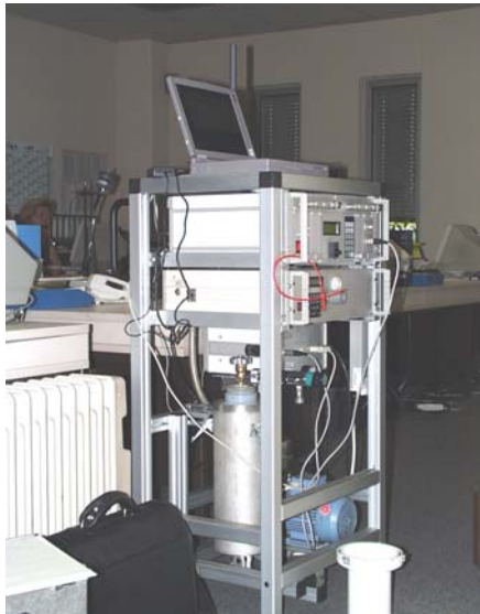
Abbildung 1: Steuer- bzw. Dosierstand des BGIA für Tracergasmessungen
