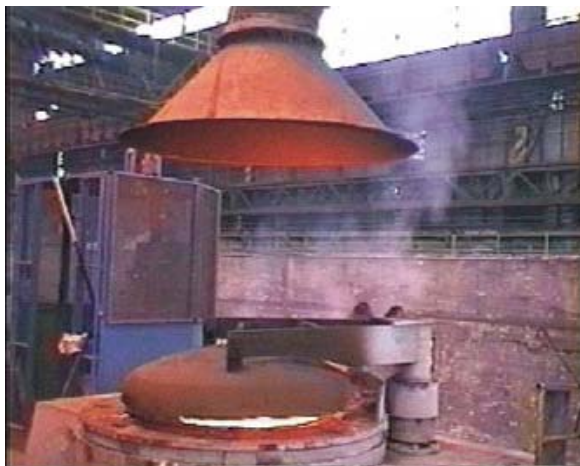
Abbildung 11: Strömungsverhältnisse an einem Schmelzofen mit konventioneller Oberhaube
