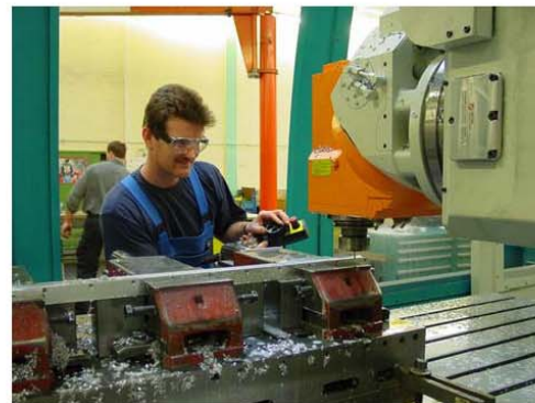
Abbildung 1: Prozessbeobachtung bei Einzelfertigung auf einem Bearbeitungszentrum. Im 1/100mm – Bereich sind Störkanten zu glätten, wobei eine Kollisionsgefahr an Werkstückkonturen besteht.
