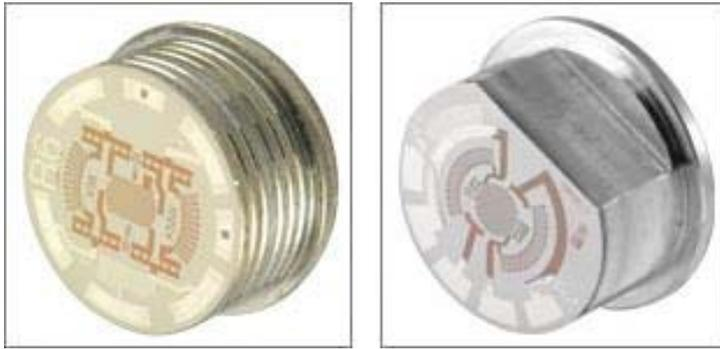
Die Dünnschicht-Druckmesszellen ( $\varnothing$  ca. 15 mm) stehen in den verschiedensten Varianten für die Druckbereiche von 25 bar bis 3.000 bar zur Verfügung. Neben den Standardsensoren mit NiCr-Schicht sind für höhere Temperaturbereiche auch Messzellen mit TiON-Schichten verfügbar. Diese TiON-Messzellen haben zudem ein höheres Ausgangssignal von 5,5 mV/V, anstatt der sonst üblichen 2 mV/V.
