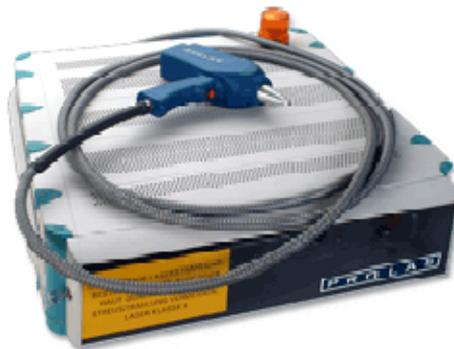
Der Handlaser wird je nach Anwendungsgebiet mit einer Laserleistung von 30 bis 100 W angeboten. Die Wellenlänge des Lasers liegt bei 940 nm. Er ist mit einer Temperaturregelung, die im ms-Takt arbeitet, ausgestattet. Versorgt wird der Handlaser über eine konventionelle 230-V-Steckdose.
