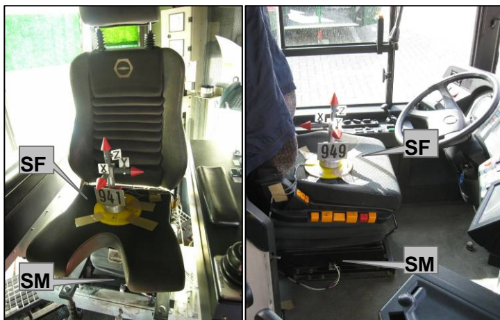
Bild 1: Die Anbringung der Beschleunigungsaufnehmer für die Ganzkörper-Vibrationen Links: Vollportalkran, Rechts: Bus (SF: Sitzfläche, SM: Sitzmontagepunkt)
