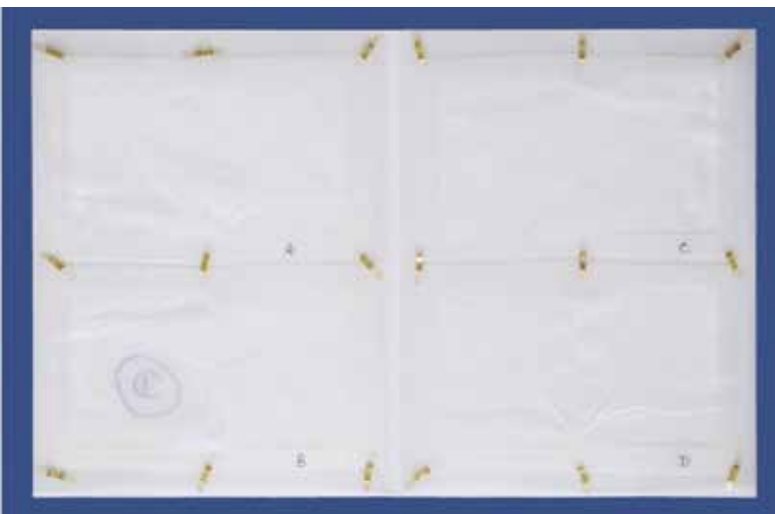
Abb. 6: Der EDC-Sampler besteht aus vier staubbindenden Tüchern, die in einer 40 x 30 cm Plastik-Faltmappe befestigt sind. Die Staubsammlung erfolgt in der horizontalen Position über einen Zeitraum von 14 Tagen.
