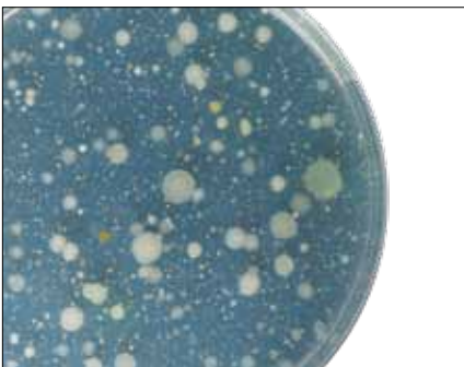
Schnelltests zeigen Wasserverunreinigungen in raumluftechnischen Anlagen an. ▶ Seite 24
