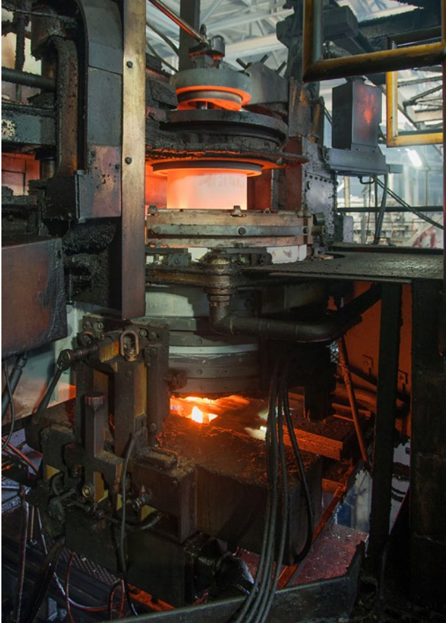
Abb. 1: In der Schmelzwanne des Ofens werden Quarzsand, Soda und Kalk sowie Altglas auf etwa 1600°C erhitzt.
