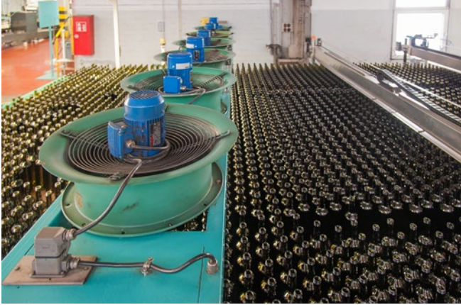
Abb. 2 und 3: Kühlöfen sorgen für spannungsfreies Erkalten der Produkte.
