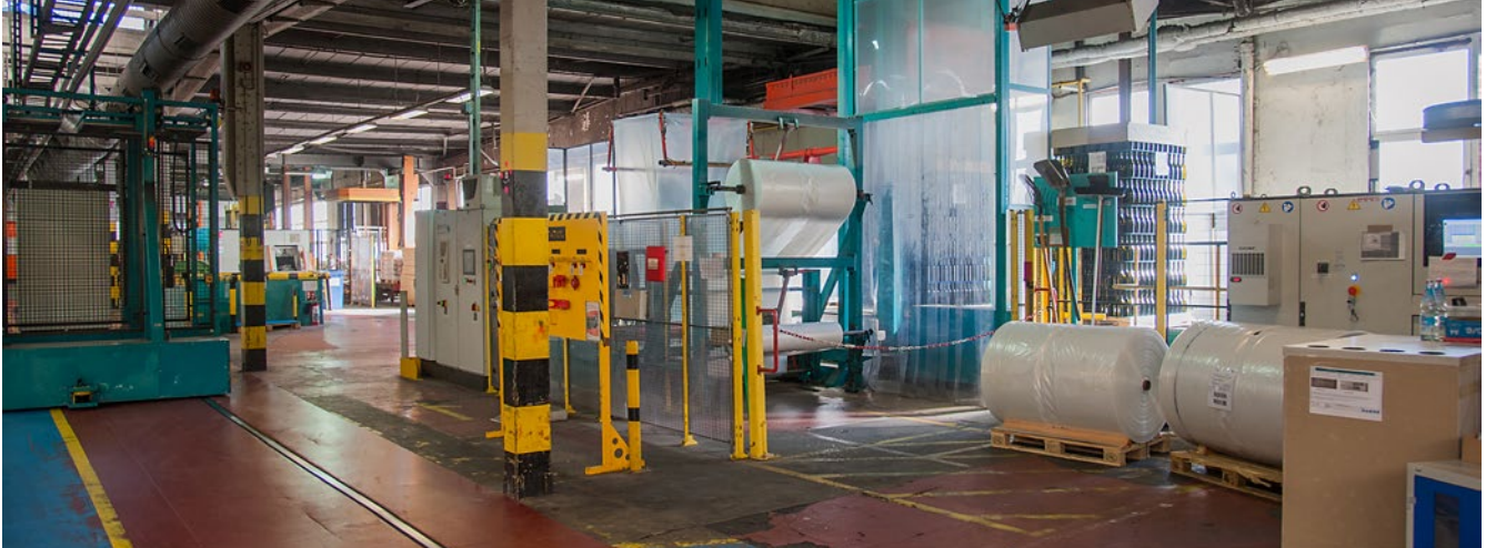
Abb. 4: Am „Cold-End“ der Produktion werden die fertigen Flaschen automatisiert auf Paletten verpackt.
