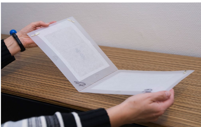
Abb. 2 Elektrostatistischer Staubsammler (electrostatic dust sampler = EDC)
