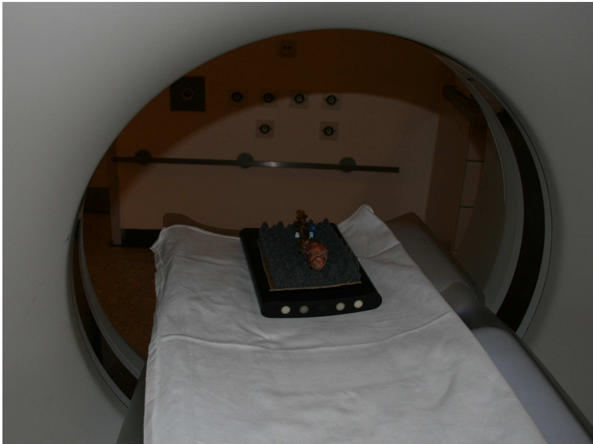
Abbildung 4: Humanes Testpräparat auf Knochendichtephantom im CT.
