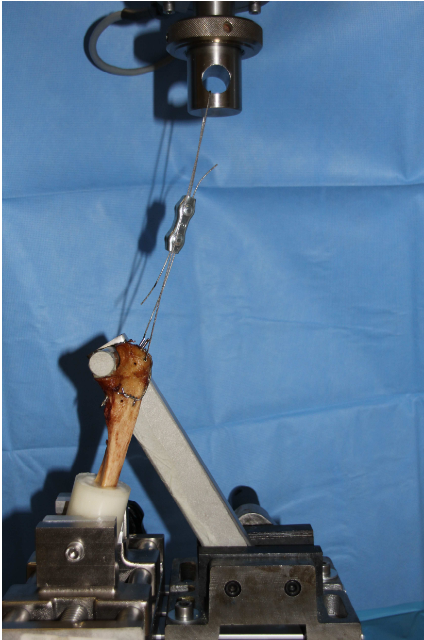
Abbildung 12: Simulierter Lastfall 30° Flexion im Ellenbogengelenk.
