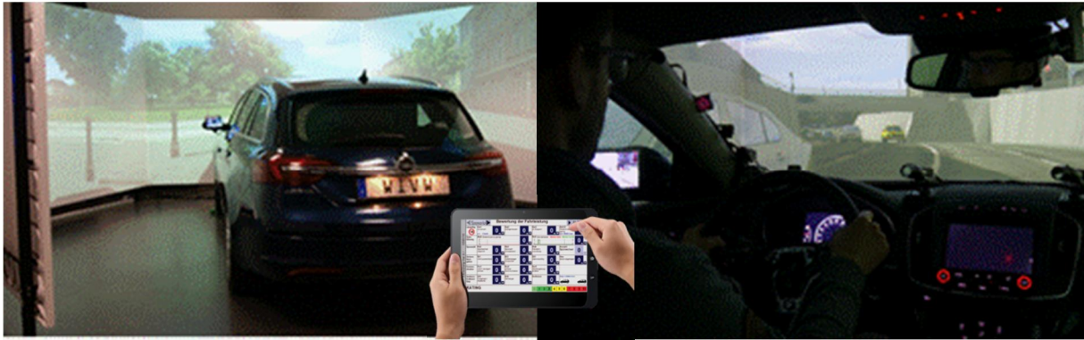
Abbildung 1: Statischer High-End Fahrsimulator des Würzburger Instituts für Verkehrswissenschaften, in dem die Expositionstherapie stattfand, Außen- (links) und Innenansicht (rechts), sowie Tablet-PC (Mitte) für die Registrierung von Fahrfehlern und Auffälligkeiten im Fahrverhalten (Standardized Application for Fitness to Drive Evaluation S.A.F.E.).
