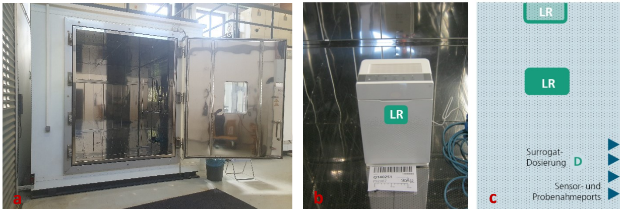
Abbildung 1 a-c: a geöffnete 30 m 3 Edelstahl-Prüfkammer; b Ansicht Prüfling in Kammer positioniert; c schematische Darstellung der Positionen, Blick von oben auf den Kammerboden (LR Luftreiniger, D Phagendosierung, ▶ Probenahmeports in der Kammerwand)
