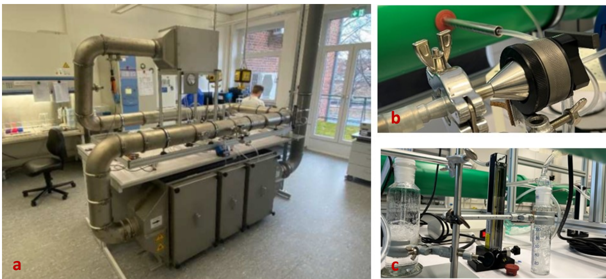
Abbildung 3 a-c: a) Edelstahl-Prüfkanal in S2-Labor am Standort ITTN; b + c) Probenahmen mit Sammelköpfen und Impingern an vorläufigem baugleichen Prüfkanal aus mineralfaserverstärkten Polypropylen-Kanalgrundrohren zur Findung der optimalen Messpositionen
